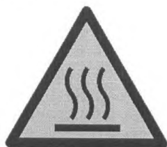
Рисунок 15 — Предупреждающий знак «Опасность от нагретой поверхности»
